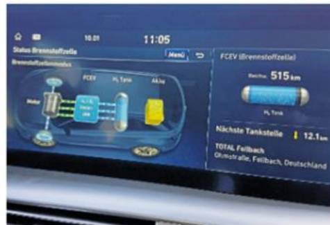
Das Panel im Auto zeigt alle wichtigen Daten rund um die Brennstoffzelle.
